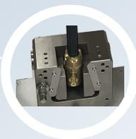
Tous les raccords à compression sont testés suivant la norme NF EN ISO 3503 et ISO 17885:2015
