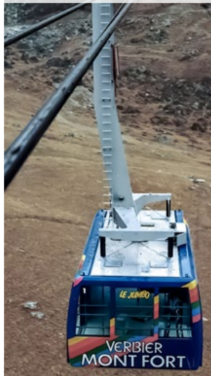
Seilbahnkabine mit Pendeldämpfung // Ropeway cabin with oscillating damping
