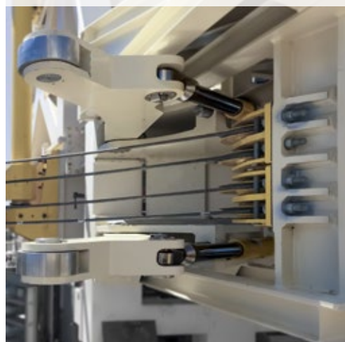
Dämpfung für Raumschiffstütze // Damping for space craft support structure
